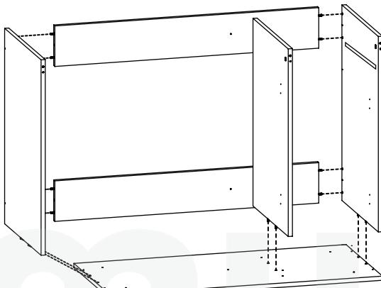
INTRODUCIR LOS TORNILLOS EN LOS ORIFICIOS Y AJUSTARLOS A TOPE. CUBRIR LOS LATERALES CON EL TAPÓN PLASTICO.
