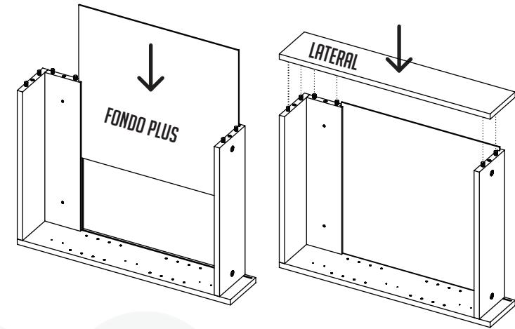
AJUSTAR LOS TAMBORES DE MINIFIX DEL TECHO, TRAVESAÑO TRASERO Y BASE, COMO LO INDICA LA FIGURA. LUEGO COLOCAR LOS TORNILLOS EN LOS ORIFICIOS UBICADOS EN EL TECHO.
