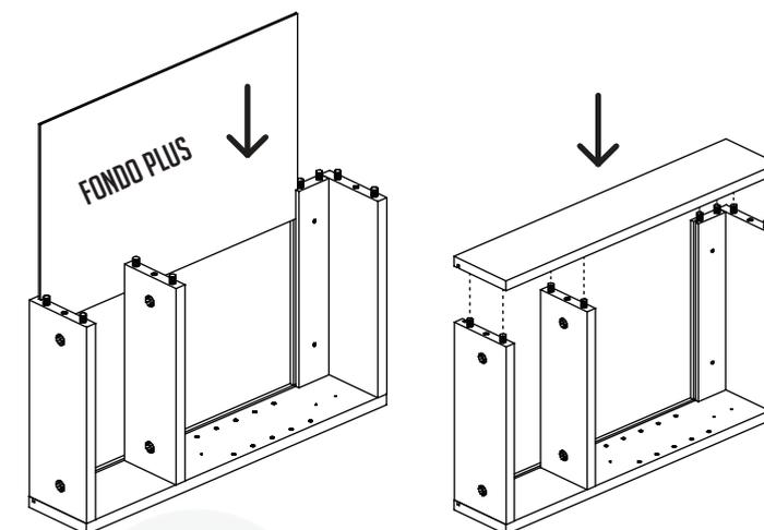
AJUSTAR LOS TAMBORES DE MINIFIX DEL TECHO, ESTANTE FIJO Y PISO, COMO LO INDICA LA FIGURA. LUEGO COLOCAR EL TORNILLO EN EL ORIFICIO UBICADO EN EL TECHO. POSTERIORMENTE INTRODUCIR EL TAPÓN BLANCO.
