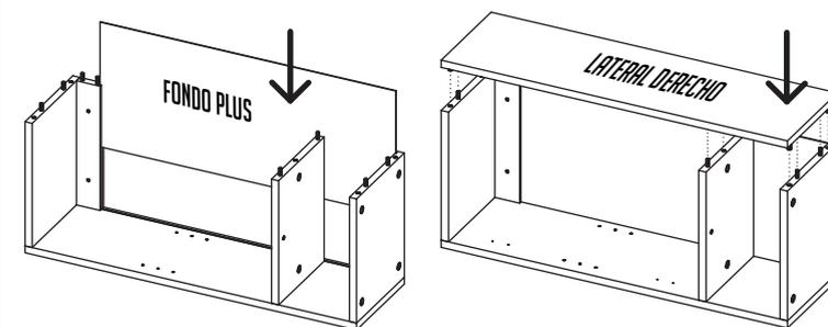
GIRAR EL MUEBLE Y AJUSTAR LOS TAMBORES DE MINIFIX DEL TECHO, ENTREPISO Y PISO, COMO LO INDICA LA FIGURA. LUEGO AJUSTAR TORNILLO EN EL ORIFICIO UBICADO EN EL TECHO. COLOCAR EL TAPÓN CORRESPONDIENTE.
